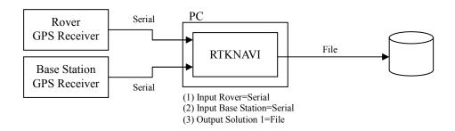
(4) RTK-GPS (ローバシリアル入力+ファイル出力、基準局:無線 LAN 経由接続)
