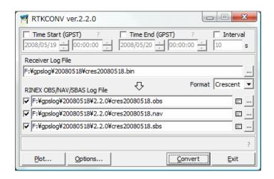
(2) Receiver Log File に受信機ログファイルを指定してください。サポートしている受信機およびメッセージは以下の通りです。受信機から以下のメッセージを出力するように設定して取得した受信機ログファイルを指定してください。なおドラッグアンドドロップで受信機ログファイルを指定することもできます。
