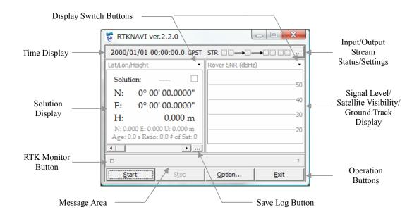
(2) リアルタイム測位 AP の実行には GPS 受信機から出力される観測データ、航法メッセージ、 SBAS 補正メッセージ等の受信機データ入力が必要になります。また測位結果データを出力 することも可能です。入出力設定を行うためメイン画面右上の「…」ボタンを押してください。入出力データストリーム設定画面が表示されます。
