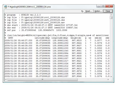
(8) 解析終了後「Plot...」ボタンを押すことにより処理結果 (測位解) を RTKPLOT プログラムにより表示することができます。 RTKPLOT プログラムの操作については 2.7 測位解・観測データのプロットを参照ください。
