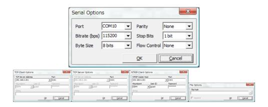
(4) 入力データストリーム種別が Serial の場合、Cmd 下の「…」ボタンを押して接続開始、接続終了時に GPS 受信機に送信するコマンドを指定することができます。この機能を使って測位開始・終了時に GPS 受信機に対し観測データ出力開始・停止等を指示したり、モデムに接続・切断コマンドを送信したりすることができます。なお Commands at startup または Commands at shutdown のチェックが off の場合コマンドは送信されません。
