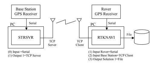
(5) RTK-GPS (ローバシリアル入力、基準局:携帯パケット回線-インターネット経由)
