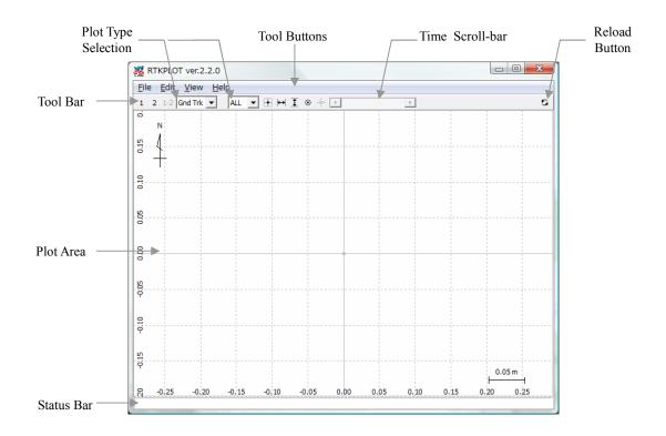
(2) メニュー「File」「Open Solution 1」を実行して表示された Open Solution ダイアログで読み込む測位解ファイルを指定してください。測位解ファイルは RTKNAVI や RTKPOST が出力した解析結果データ (測位解) 以外に NMEA-183 形式のファイルも指定可能です。NMEA-183 形式の場合、最低限 GPRMC、GPSGGA センテンスが含まれている必要があります。測位解が正常に読み込まれた場合画面上に測位解に従った地上軌跡が表示されます。
