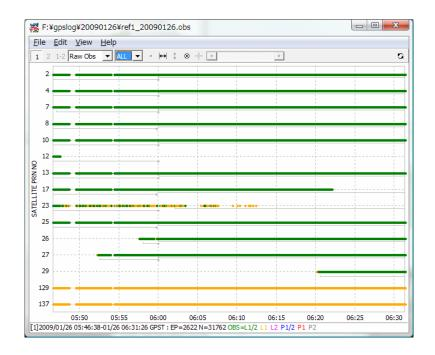
(12) 画面左上のプロット種別選択ドロップダウンリストの操作によりプロットする内容を観測 データ、スカイプロット、DOP・衛星数に切り替えることができます。
