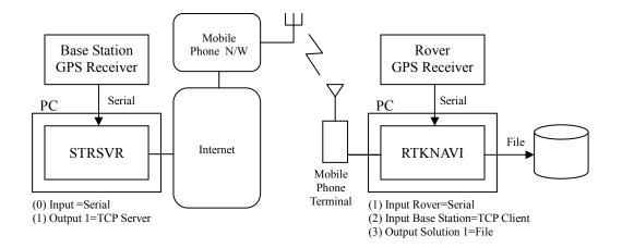
(6) RTK-GPS (ローバシリアル入力、基準局:インターネット NTRIP Caster 経由)
